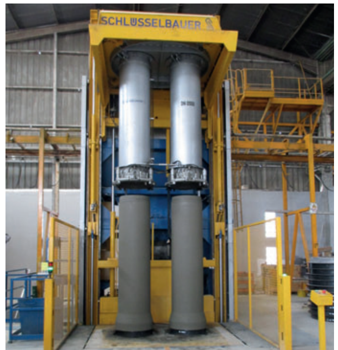
L'installation Precise livrée par Schlüsselbauer Technology peut travailler en production simple ou double. Chez SCG deux tuyaux en béton sont produits à une haute cadence, remarquable même au niveau international..
